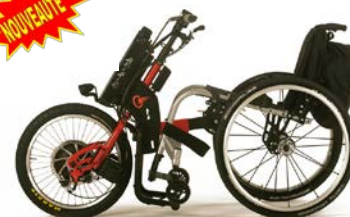
BATEC ELEC PARA Motorisation électrique pour chaise active Cinquième roue tractant la voiturette. Montage et démontage rapide en 3 sec. Vitesse 22 km/h, 30 km/h en option. Autonomie 25-30 km. PRIX : 5194 € DEMANDEZ UN ESSAI !
